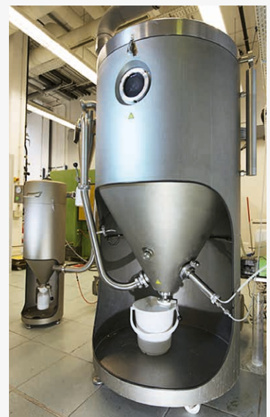
Aufskalierungsequipment mit 100 L Batchreaktor (links), halbkontinuierlicher Zentrifuge (Mitte) und Sprühtrockner im Technikumsmaßstab (rechts).
